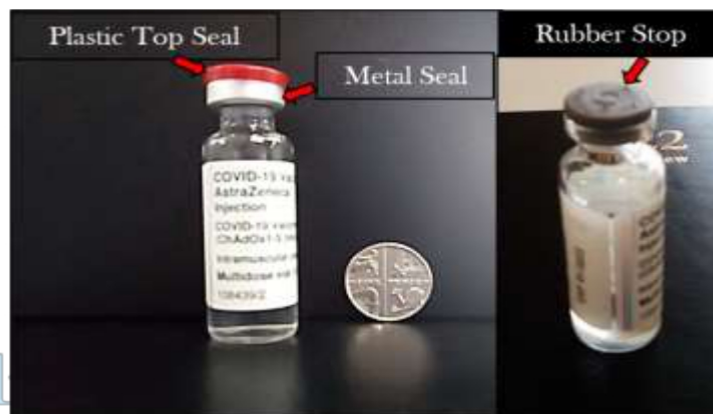
Figura 2-1 Diferentes partes del proceso de sellado del vial. El vial mostrado aquí es el de AstraZéneca. Los tres mismos componentes de sellado estaban presentes en los viales Moderna y Pfizer.
