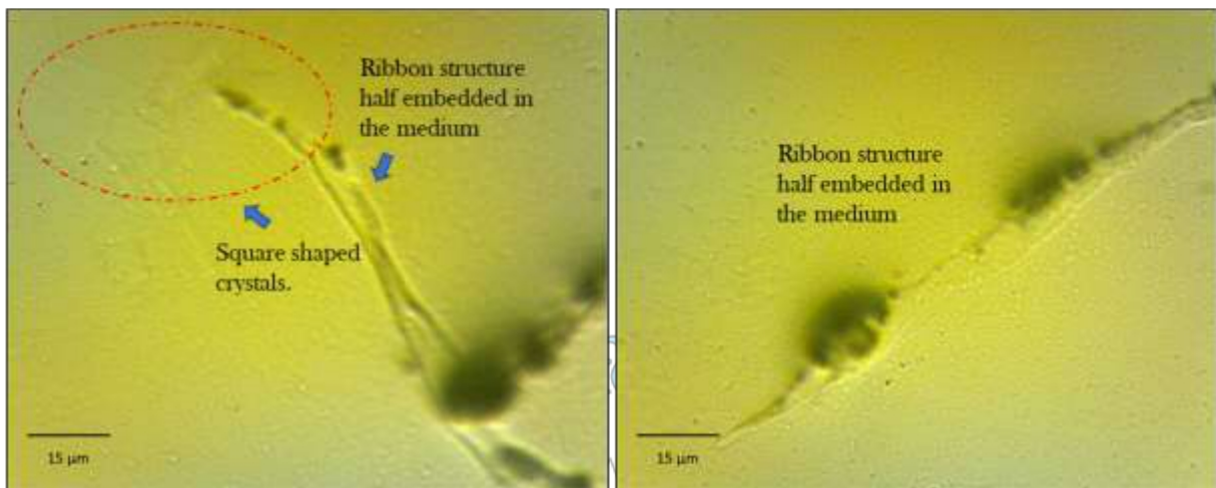
Figura 3.8. Formas de cinta parcialmente incrustadas en el medio. Cristales cuadrados y cuadrilaterales en el fondo.
