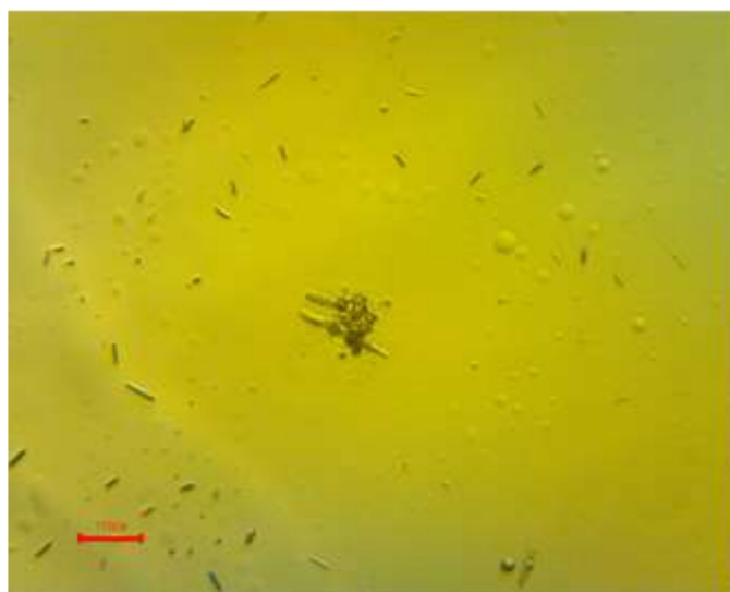
Figura 3.24. Rollos de Grafeno o espículas depositadas en el fondo del portaobjetos.
