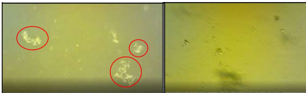
Figura 3.13. Hojas flotantes de material translúcido en una muestra húmeda observadas con microscopio óptico. (b) El material detrítico asentado en el fondo de la placa. Las sombras del material flotante más claro pueden verse como figuras oscuras y nebulosas.
