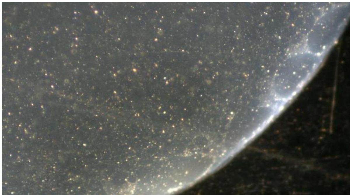
Figure 1. Image en champ sombre à faible et moyen grossissement révélant une matrice colloïdale hétérogène au sein d'une préparation pharmaceutique injectable. Une fine diffusion particulaire et une hétérogénéité réfractive sont visibles sur l'ensemble du champ, sans structures cristallines dominantes.
