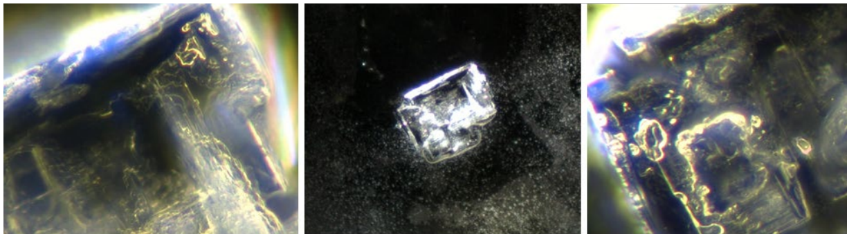
Figura 33. Nucleación de cristal tras una latencia prolongada. Se captura un cristal rectangular a dos aumentos durante su aparición, más de 20 horas después de la deposición de la gota. Izquierda: La nucleación temprana bajo iluminación oblicua muestra una morfología estratificada en la estructura en formación (aproximadamente 200x, profundidad de campo extendida). Derecha: Una vista con mayor aumento revela la compartimentación interna y la complejidad de la superficie, lo que confirma una transición de inicio tardío dentro de una gota previamente estabilizada. Se sospecha que la exposición a la luz es el desencadenante.
