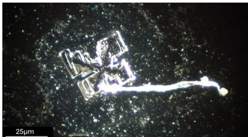
図28.水晶-ファイバー・アセンブリ」。倍率100倍。
