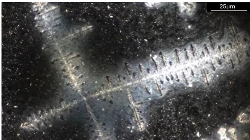
Figure 29. Cristaux en forme d'aiguilles formés pendant l'évaporation de gouttelettes sessiles (SDE) avec l'ajout d'un échantillon supplémentaire pendant la phase liquide. Les pointes noires distinctives mettent en évidence une caractéristique de cristallisation unique résultant de cette manipulation. Grossissement 100x.
