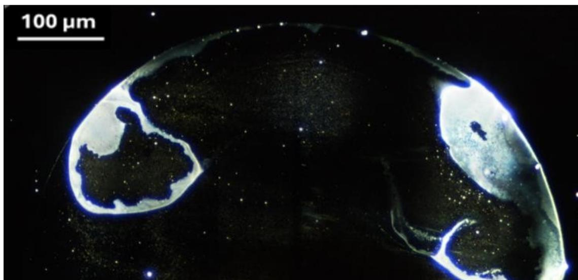
Abbildung 139. Getrocknetes Rosenwasser mit Randkristallisationsmuster und Ablagerung von kolloidalen Partikeln. Vergrößerung 25x.
