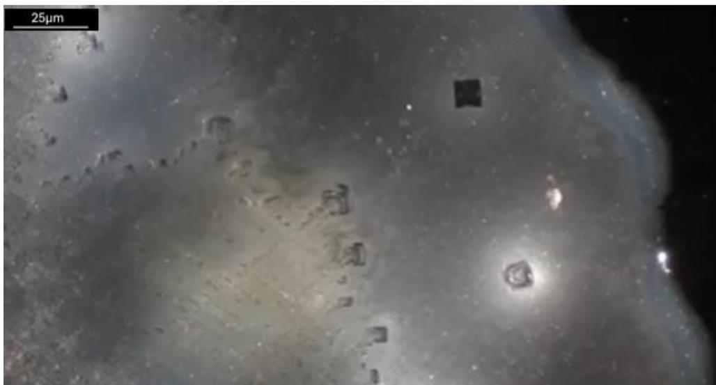
Abbildung 36. Eine breitere Ansicht in der Nähe des Tröpfchenrandes zeigt deutliche Kristallbildungen, die durch die Kolloidverteilung in diesem Bereich beeinflusst werden. Dieses Bild verdeutlicht die Beziehung zwischen Umweltgradienten und der Variabilität der Ergebnisse der Selbstorganisation. Vergrößerung 100x.
