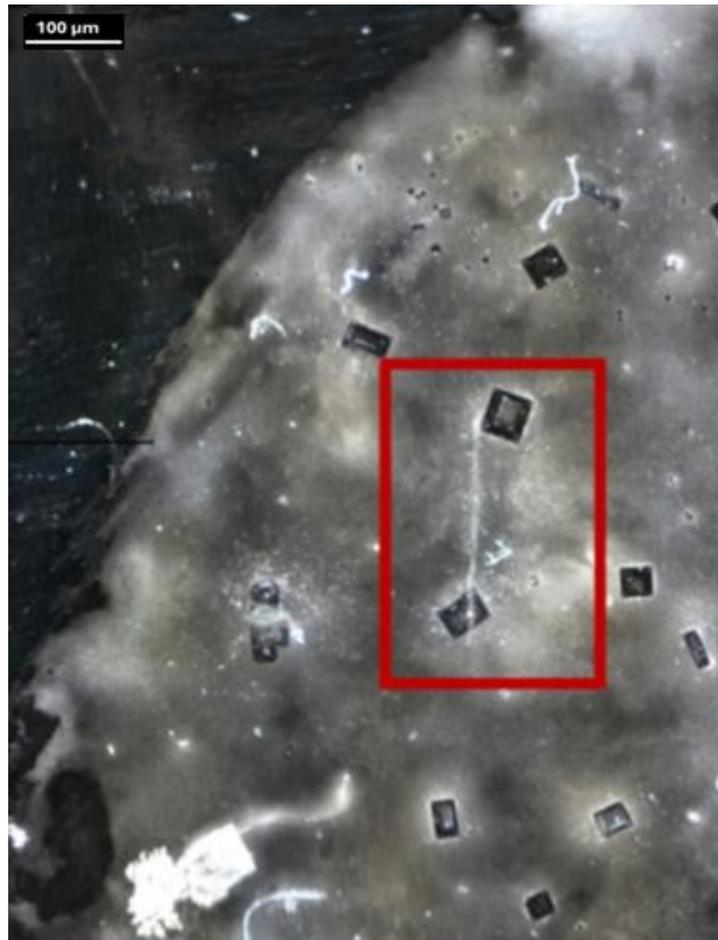
Abbildung 102. Bild mit geringer Vergrößerung des Tröpfchenrandes nach zwei Monaten, das den Übergang der kristallinen Strukturen von anfänglichen weichen Formationen zu größeren, besser organisierten Architekturen zeigt. Der markierte Bereich zeigt die Position einer "Crystal-Fibre Assembly" (CFA), wie in Abbildung 92 beschrieben, und bietet einen Anhaltspunkt für Hypothesen über strukturelle Organisationsmechanismen innerhalb der Matrix. Vergrößerung 25x.
