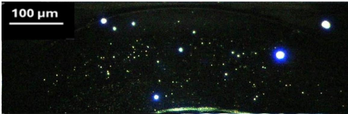
Abbildung 140. Ein Tropfen Leitungswasser zeigt dispergierte Kolloide und größere reflektierende Verunreinigungen unter dem Dunkelfeldmikroskop. Die hellen Punkte weisen auf suspendierte Partikel hin, während die größeren Reflexionen auf mineralische oder umweltbedingte Verunreinigungen hinweisen, die für hartes Wasser typisch sind. Vergrößerung 25x.
