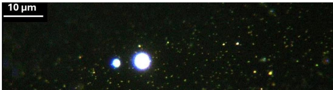
Abbildung 141 zeigt dispergierte Kolloide und größere reflektierende Verunreinigungen. Die Kolloide erscheinen als feine, helle Punkte, während die größeren, intensiven Reflexionen auf mineralische oder partikuläre Verunreinigungen hinweisen. Vergrößerung 100x.
