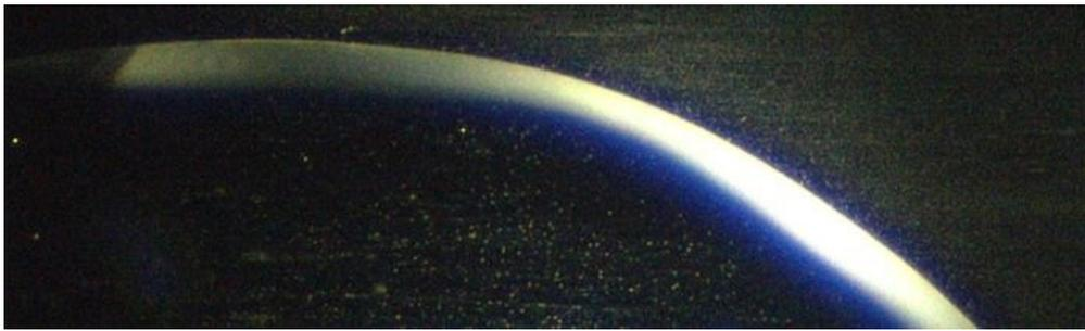
Abbildung 147. Anfängliches Trocknungsmuster einer PEG 400-Lösung, das eine gekrümmte Trocknungskante mit dispergierten Partikel auf dem gesamten Feld, was auf die hygroskopischen Eigenschaften der Lösung hinweist. Vergrößerung 25x.
