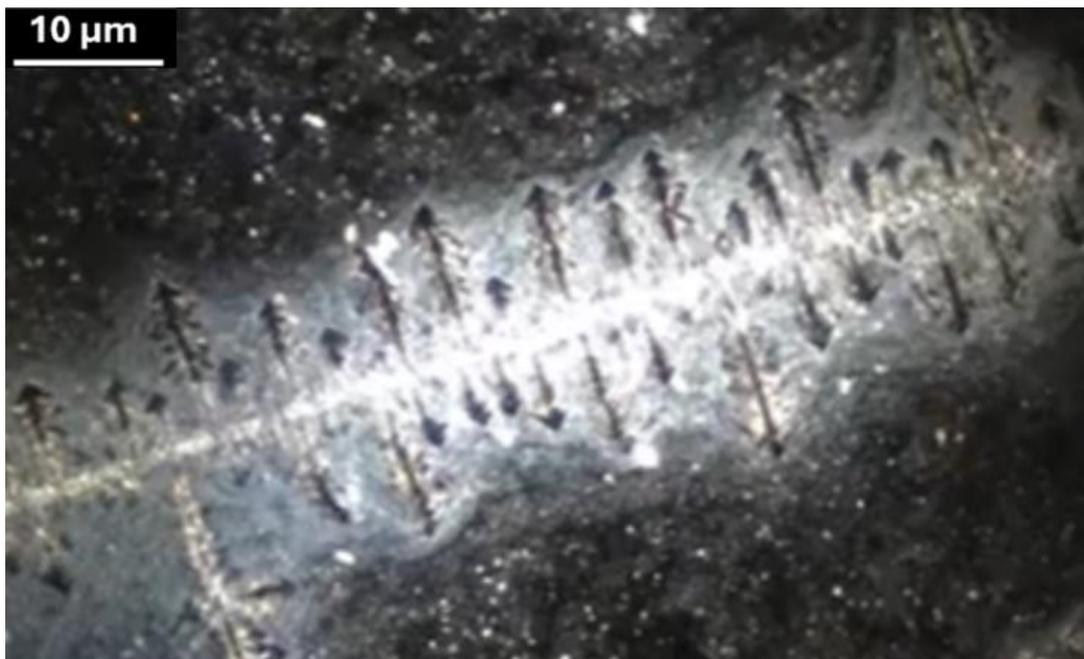
Abbildung 30. Nahaufnahme der nadelartigen Kristalle, wobei die schwarzen Spitzen an den Verzweigungsenden hervorgehoben werden. Dieses Detail zeigt die lokale Dynamik der gelösten Stoffe und Materialvariationen innerhalb der manipulierten Kristallisationsumgebung. Vergrößerung 200x.
