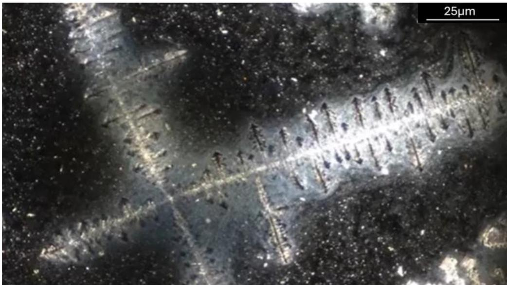
Abbildung 29. Nadelartige Kristalle, die sich bei der Sessile Droplet Evaporation (SDE) durch die Zugabe von mehr Probe in der flüssigen Phase bilden. Die markanten schwarzen Spitzen heben ein einzigartiges Kristallisationsmerkmal hervor, das sich aus dieser Manipulation ergibt. Vergrößerung 100x.
