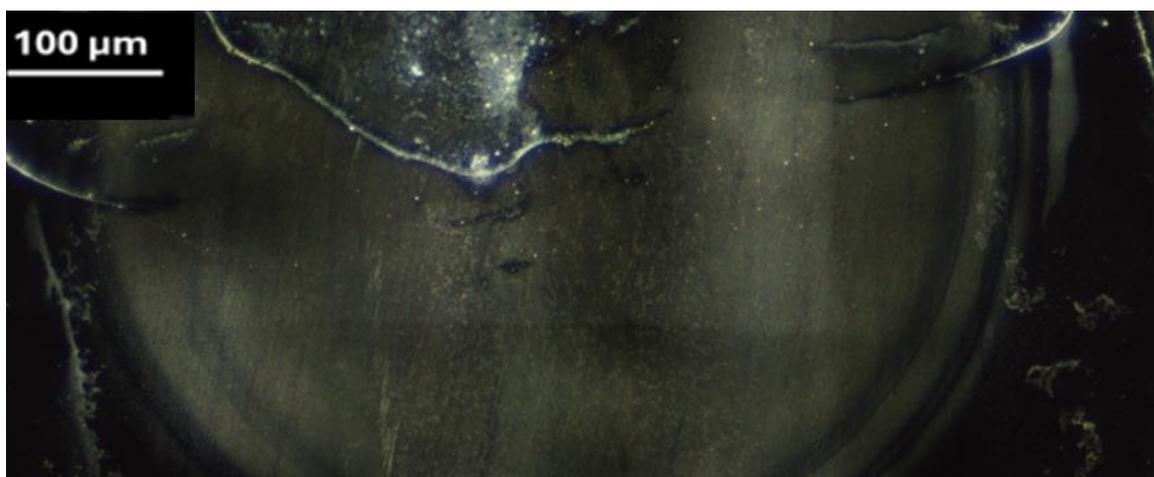
Abbildung 128. Trocknungsmuster von RO-Wasser mit Randstrukturen. Vergrößerung 25x.
