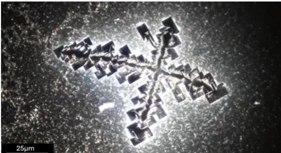
Abbildung 32. Fortgeschrittene kristalline Formation als Ergebnis der iterativen Manipulation des SDE-Prozesses. Vergrößerung 100x.
